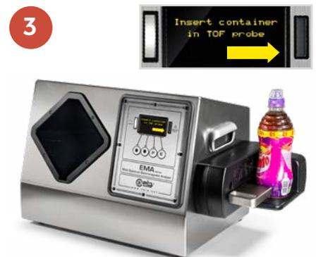
Pour compléter l'analyse, le contenant est placé dans la sonde TOF.
