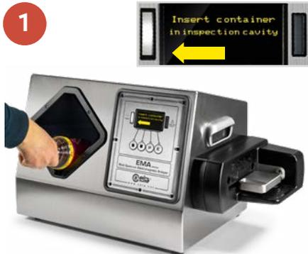
Lorsque l'opérateur place la bouteille dans la cavité d'analyse, sa présence est automatiquement détectée et le processus d'analyse est lancé
