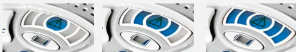
Indication visuelle proportionnelle à l'intensité du signal de la substance radioactive [en option]
